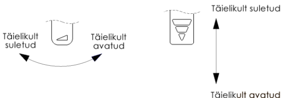
Joonis 5. Kamina õhuava reguleerimise näide (tuhaaluse esikülj)
