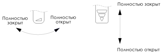
Рис. 5. Образцовая регулировка подачи воздуха в очаг (вид фасады зольника).
