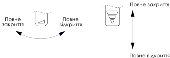
Рис. 5. Приклад регулювання подачі повітря в топку.
