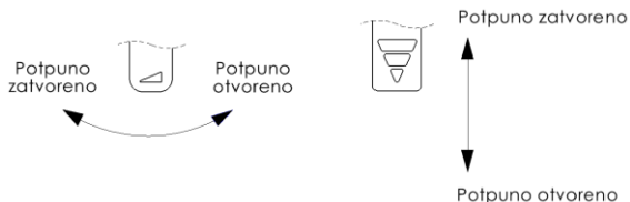
Crtež 5. Primjer regulacije dotoka zraka u ložište.
